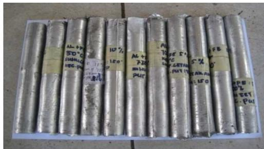
Gambar 3.23 Spesimen Hasil Pengecoran
