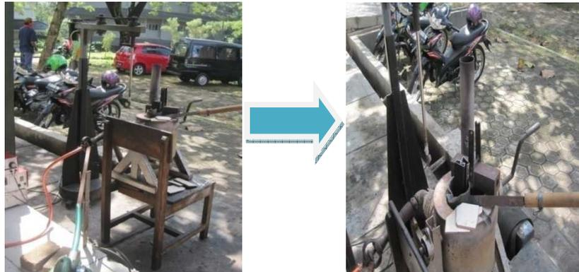
Gambar 3.20 Proses peleburan menggunakan tungku *krusibel*.
