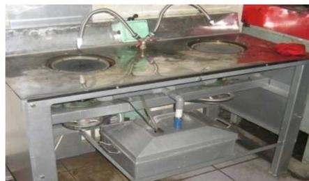
Gambar 3.12 Mesin Amplas Dan Poles
