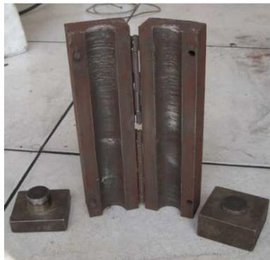
Gambar 3.7 Cetakan Logam Silinder
