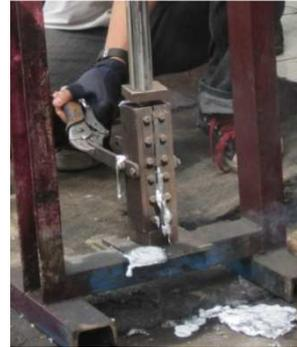
Gambar 3.22 Proses Penuangan dan Pengepresan
