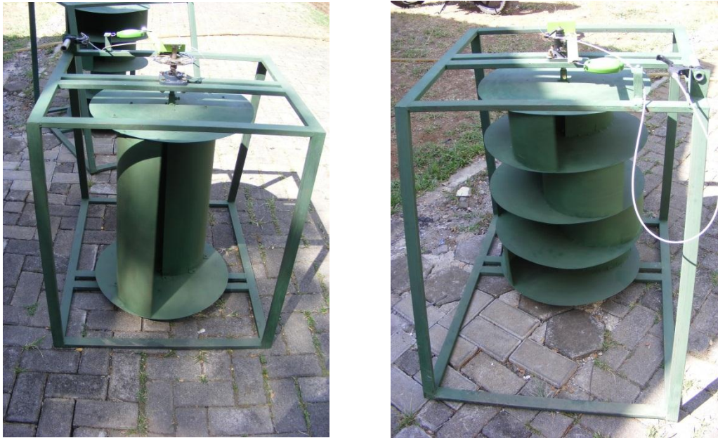
Gambar 3.3 Model rotor turbin Savonius yang diuji
