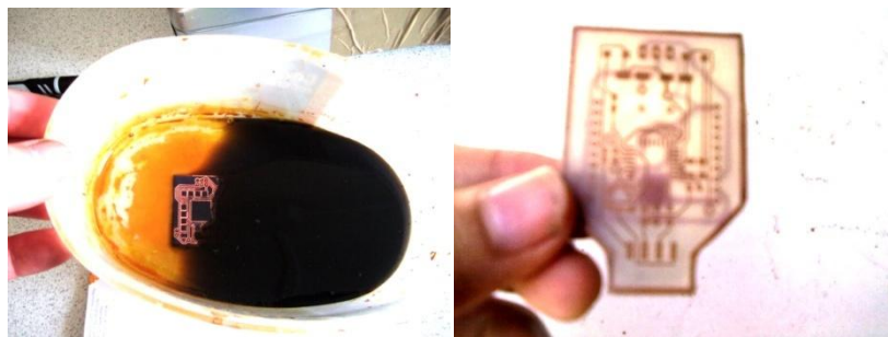
Gambar 3.16 (a) proses etsa pcb (b) hasil etsa
