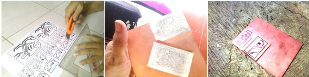
Gambar 3.15 Transfer pola rangkaian elektronika ke pcb
