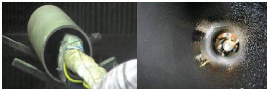
Gambar 2.9 Proses pelapisan dengan metode penyemprotan [2]
