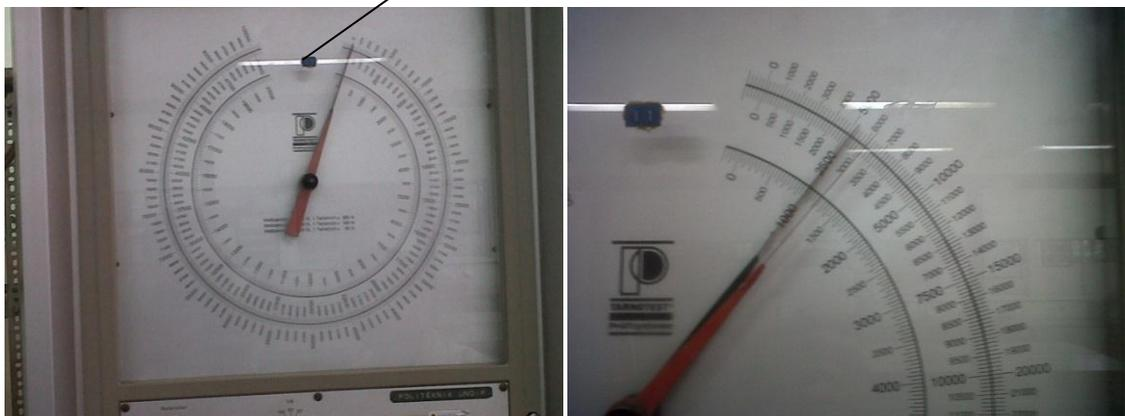
Gambar 3.31 Indikator mesin uji tekan
