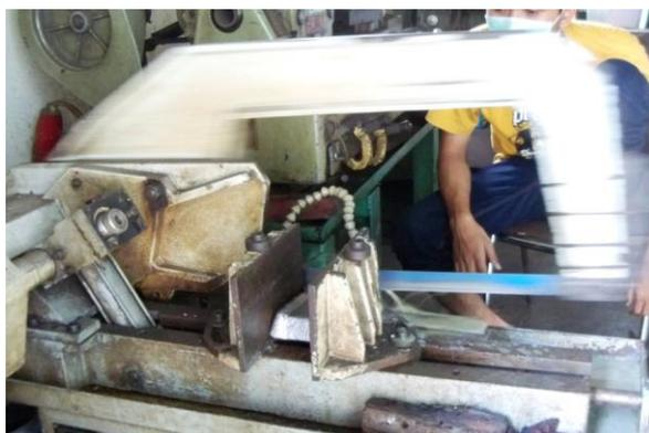
Gambar 3.18. Proses Pemotongan Al-Si Batangan.
