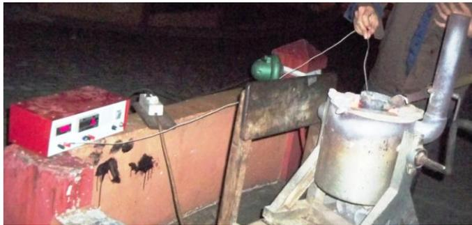
Gambar 3.23. Pengukuran Temperatur Penuangan.
