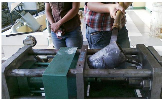
Gambar 3.24. Proses Penuangan ke Cetakan HPDC.
