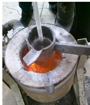
Gambar 3.22. Proses *Stir Casting*.
