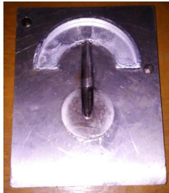
Gambar 3.7. Cetakan Sepatu Rem.
