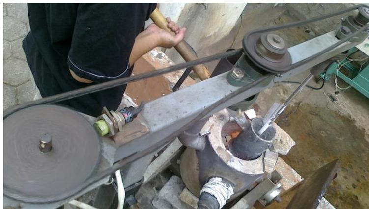
Gambar 3.8. *Stir Casting*
