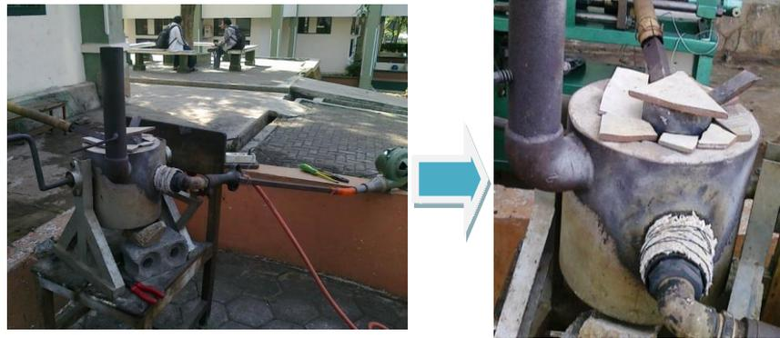
Gambar 3.21. Proses Peleburan Menggunakan Tungku Krusibel.
