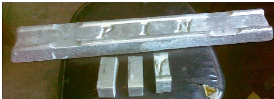
Gambar 3.16. Al-Si (ADC12) Batangan.
