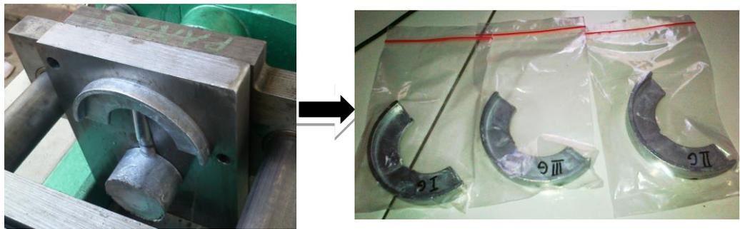
Gambar 3.25. Spesimen Hasil Pengecoran HPDC.
