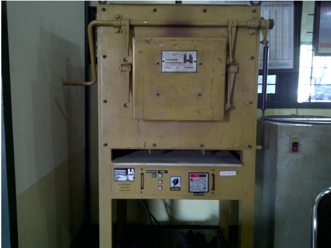
Tungku Hoffman untuk proses sintering
