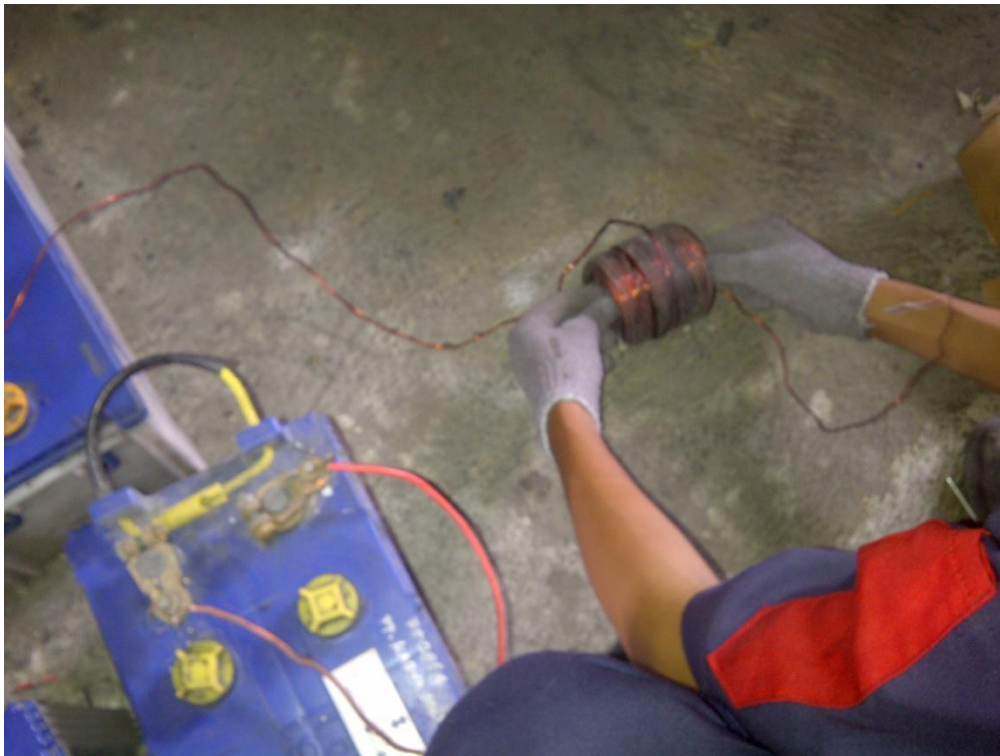
Proses magnetisasi induksi elektromagnetik
