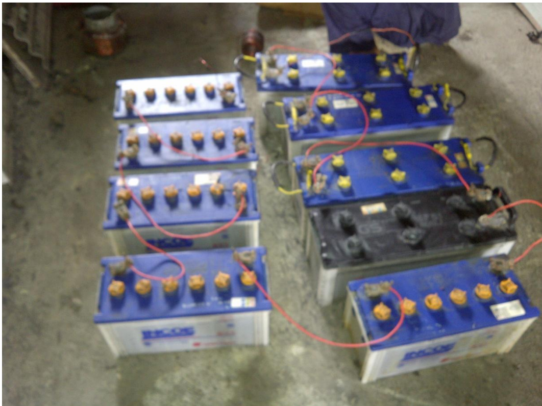
Sumber tegangan dalam proses magnetisasi
