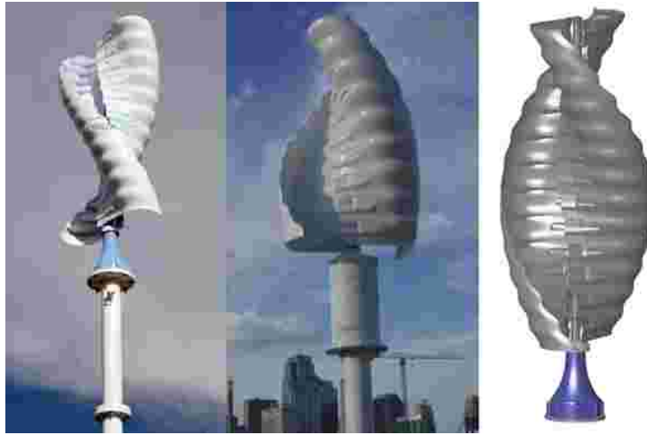
Gambar 2.18 Rotor Savonius berbentuk heliks [15]
