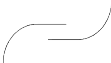
Gambar 2.16 Savonius dua bucket bentuk “L” dengan overlap [11]
