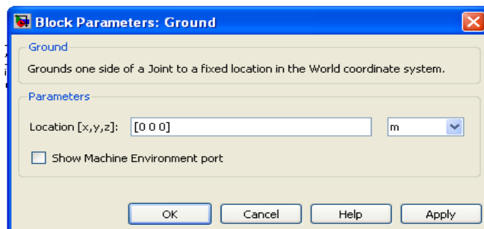
Gambar 3.5 Kotak dialog pada blok Ground .
