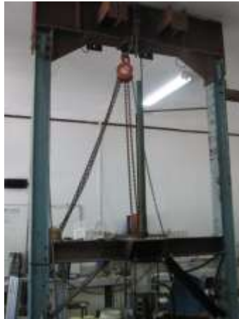
Gambar 3.10 Frame uji tekan dinding
