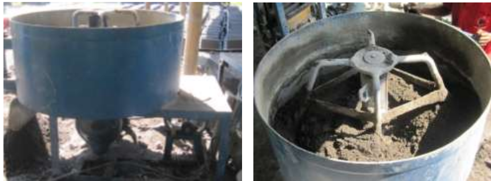
Gambar 3.1 Proses pencampuran bahan BTPTP pada mesin pengaduk
