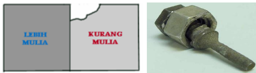
Gambar 2.10 Korosi dwi logam [4].
