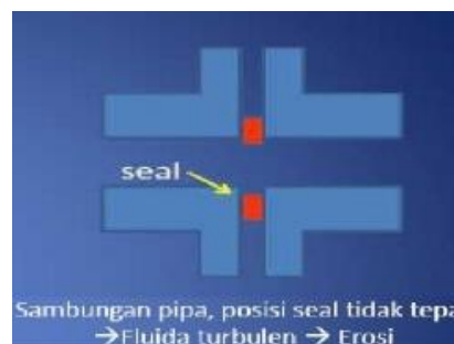
Gambar 2.20 Sambungan pipa, posisi seal tidak tepat [12].
