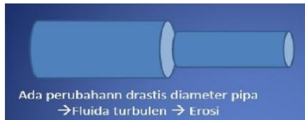
Gambar 2.19 Perubahan drastis diameter pipa [12].
