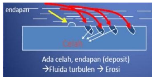
Gambar 2.21 Ada celah, endapan (deposit) pada pipa [12].
