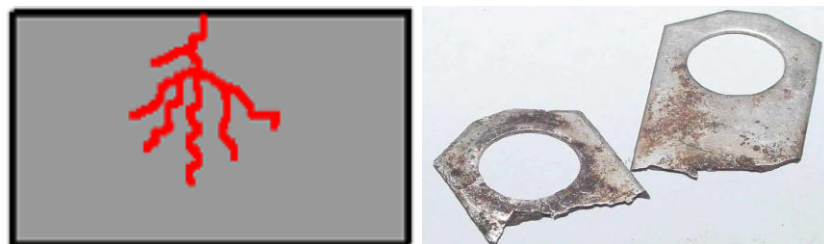
Gambar 2.14 Korosi retak tegang [4].
