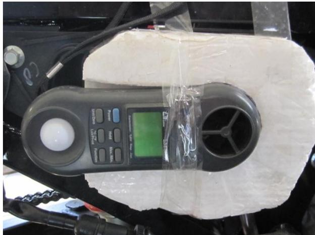
Gambar 3.14 Anemometer
