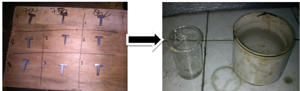
Gambar 3.28. Pemberian Etsa pada Spesimen Uji.
