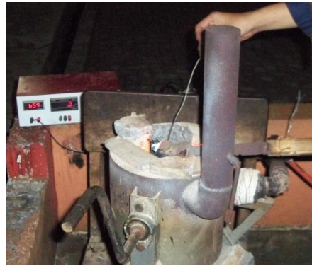
Gambar 3.20. Pengukuran Temperatur Penuangan.
