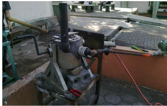
Gambar 3.19. Proses Peleburan Menggunakan Tungku Krusibel.
