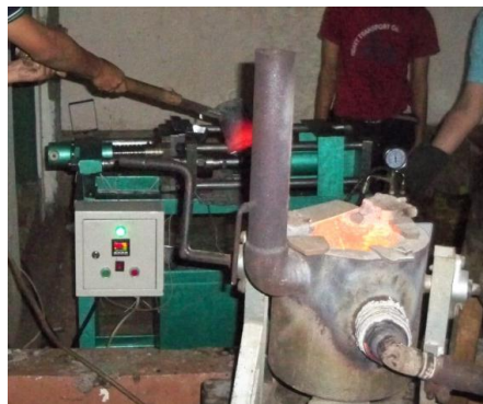
Gambar 3.21. Proses Penuangan ke Cetakan HPDC.
