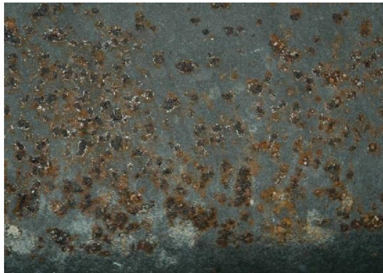
Gambar 2.19 Korosi sumuran pada bak mandi [13]
