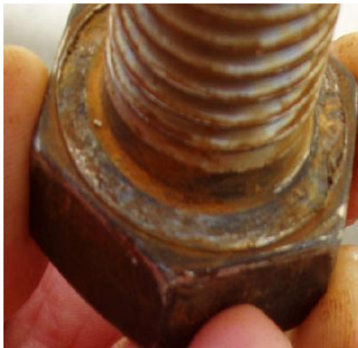
Gambar 2.16 Crevice corrosion pada baut [12]
