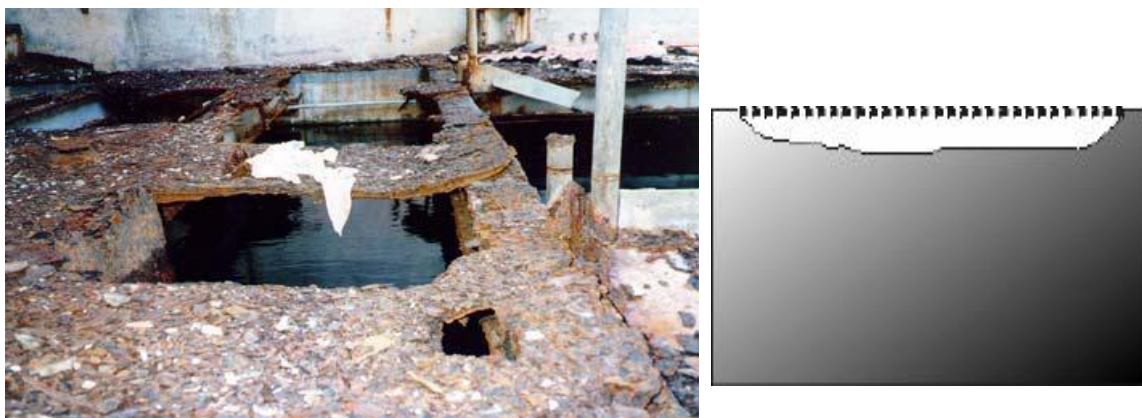
Gambar 2.14 Korosi merata pada logam [11]
