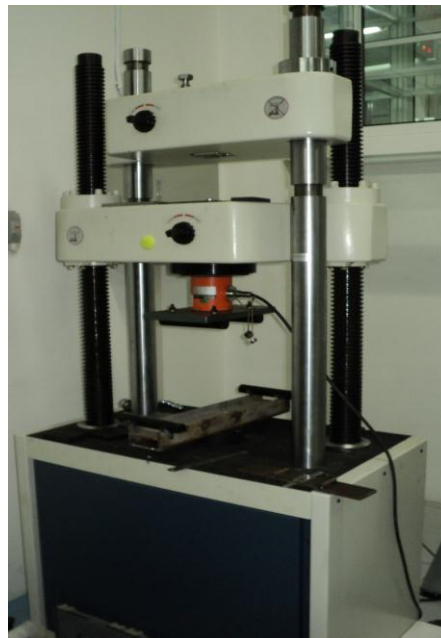
Gambar 3.6 Mesin pengujian tarik Laboratorium Bahan Dan Konstruksi Fakultas Teknik Sipil Universitas Diponegoro Semarang
