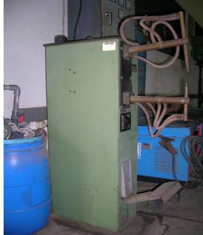
Gambar 3.5 Mesin las titik ( TECNA di Laboratorium Proses Produksi Jurusan Teknik Mesin Universitas Diponegoro Semarang)
