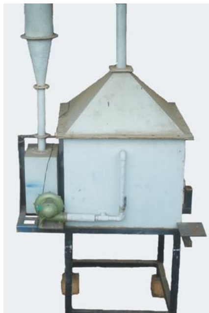
Gambar 3.4 Incenerator /Tungku Peleburan
