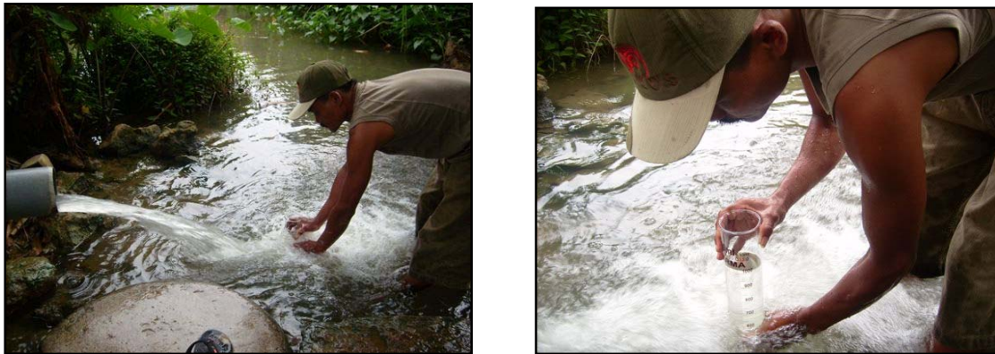
Gambar 4.9. Pengukuran Debit Mata Air Sumber: Survey, 2010
