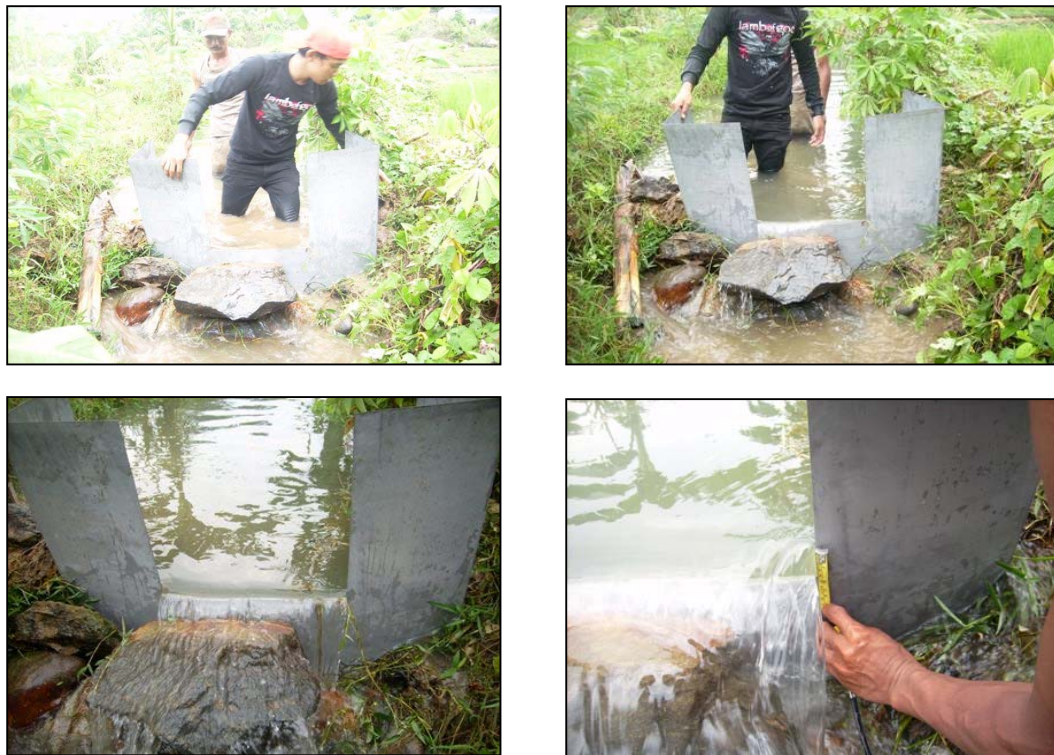
Gambar 4.8. Pengukuran kecepatan aliran permukaan Sumber: Survey, 2010
