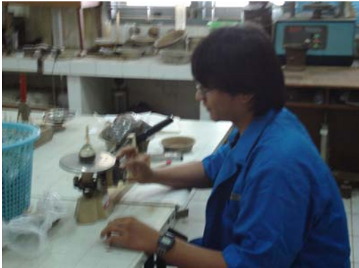
Dokumentasi 1.3. Pengujian Gs dengan Piknometer
