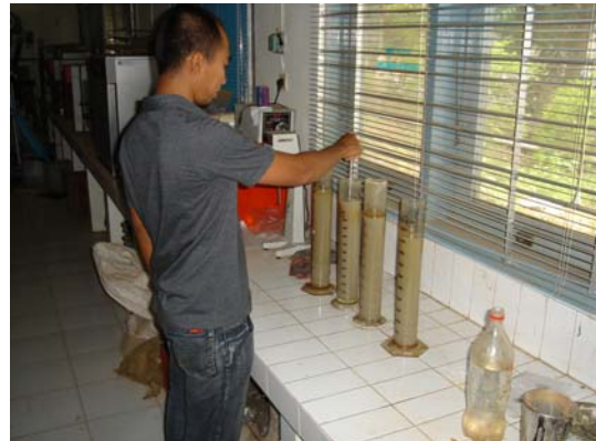
Dokumentasi 1.2. Pengujian Hidrometer
