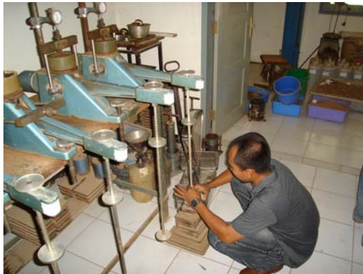
Dokumentasi 2.3. Pembebanan Untuk Uji Swell Pressure
