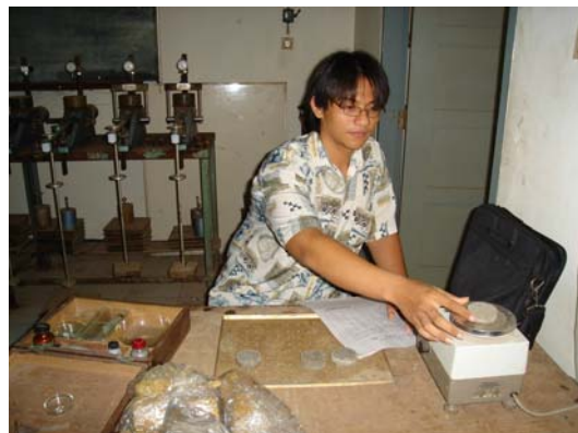
Dokumentasi 1.6. Penimbangan Benda Uji Shrinkage
