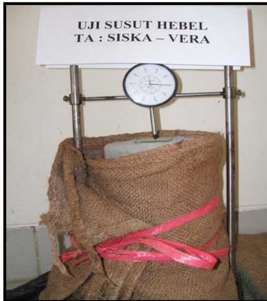
Gambar 3.12. Uji susut beton aerasi
