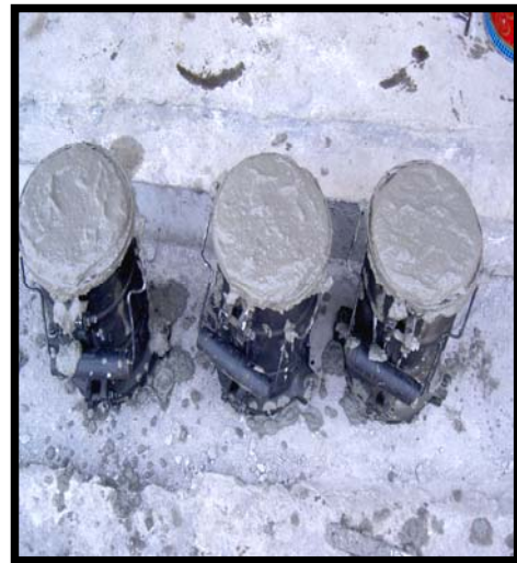
Gambar 3.8. Proses pembuatan benda uji beton aerasi
