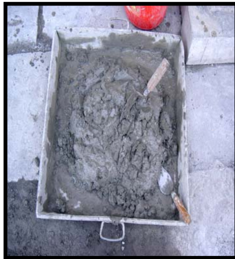
Gambar 3.7. Proses pembuatan pasta semen
