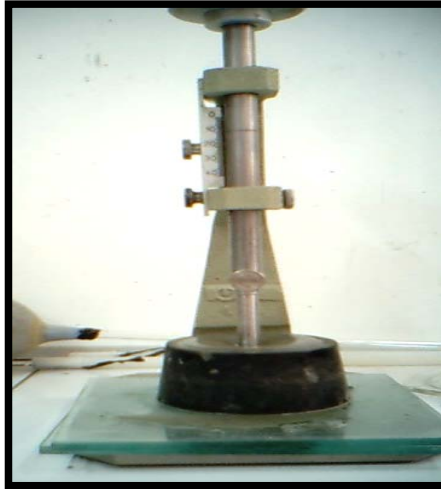
Gambar 3.3. Pengujian konsistensi normal semen
