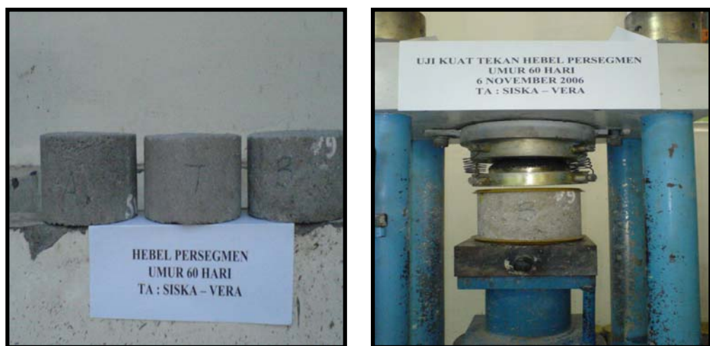
Gambar 3.11. Uji kuat tekan beton aerasi per segmen
