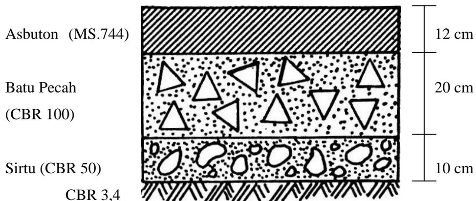
Gambar 5.1 Susunan Perkerasan
