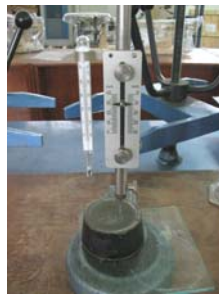
Gambar 3.3. Pengujian pengikatan awal semen
