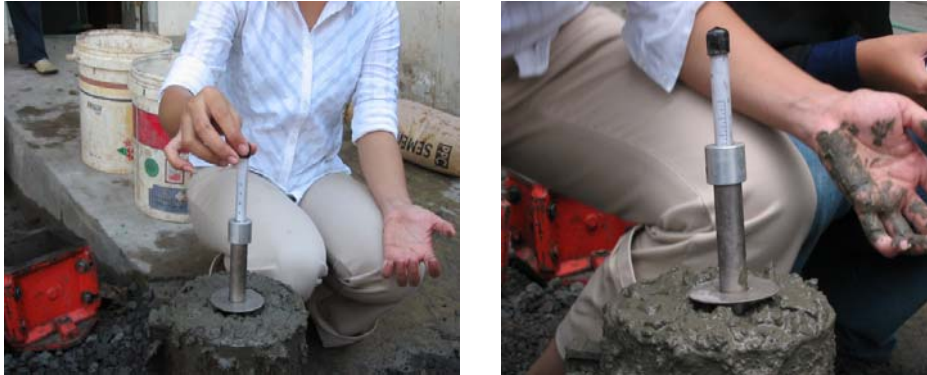
Gambar 3.8. Pengujian workabilitas dengan K- Slump
