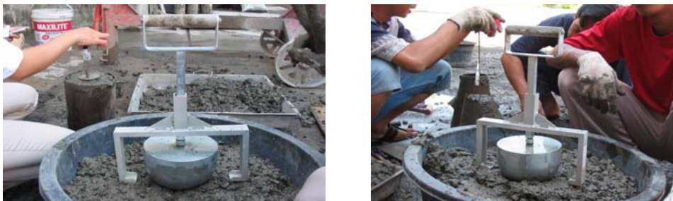
Gambar 3.9. Pengujian workabilitas dengan Kelly Ball
