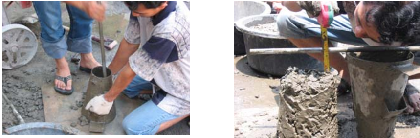
Gambar 3.7. Pengujian Workabilitas dengan Kerucut Abrams
