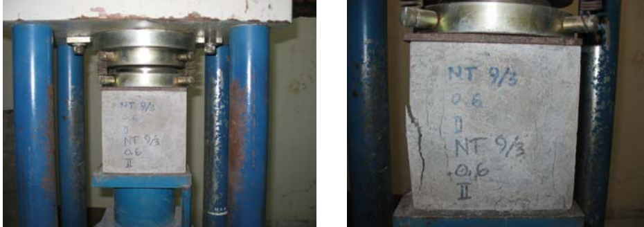
Gambar 3.13. Pengujian Kuat Tekan Beton
