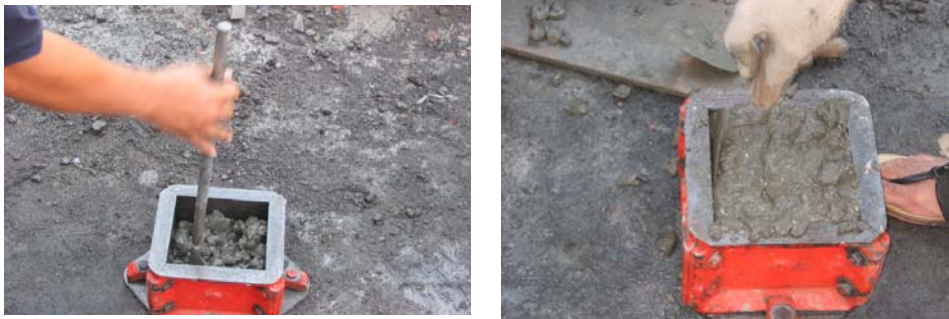
Gambar 3.10. Pembuatan benda Uji kubus
