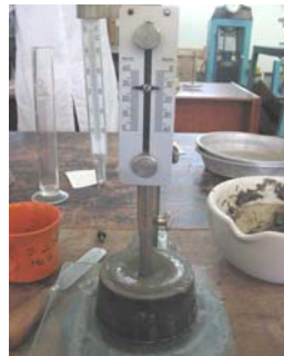
Gambar 3.2. Pengujian konsistensi normal semen
