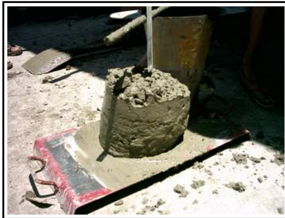
Gambar 3.5 Pemeriksaan nilai slump
