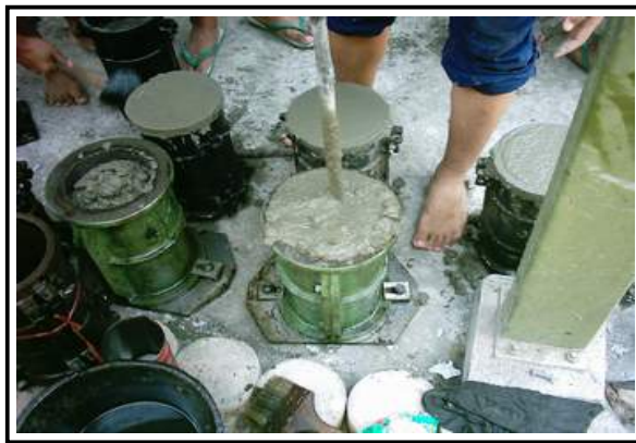
Gambar 3.6 Pembuatan benda uji silinder beton
