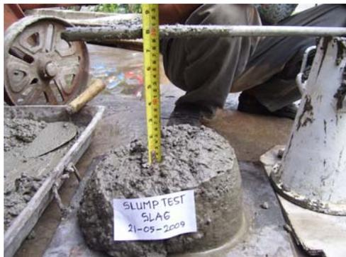
**Gambar. 3.7.** Pengujian *Slump Slag*
