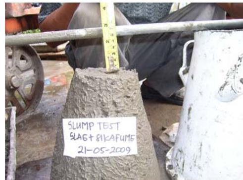
**Gambar. 3.8.** Pengujian *Slump Slag + Silica fume*
