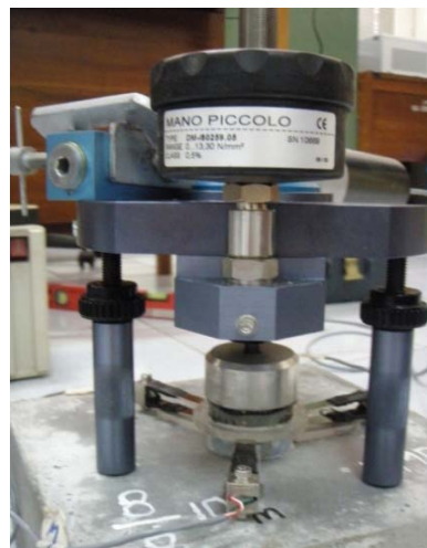
Gambar 3.5 Contoh pengujian cabut dengan alat Proceq Edm Electromotor
