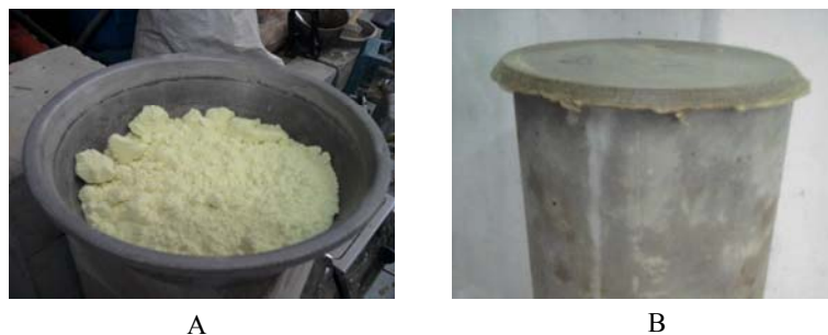
Gambar 2.7. (A) Bubuk belerang, (B). Belerang sebagai kaping
