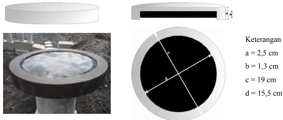
Gambar 2.8. Topi baja sebagai kaping silinder beton
