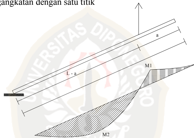
Gambar 2.9 Pengangkatan tiang pancang dengan satu titik
