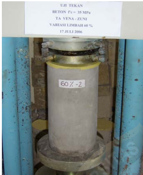
Gambar 3.7 (a) Proses Capping , (b) Penimbangan benda uji, (d) Sebelum pengujian kuat tekan, (e) Sesudah pengujian kuat tekan
