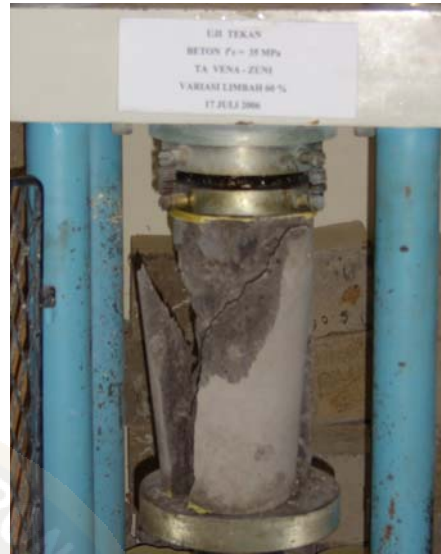
Gambar 3.7 (a) Proses Capping , (b) Penimbangan benda uji, (d) Sebelum pengujian kuat tekan, (e) Sesudah pengujian kuat tekan
