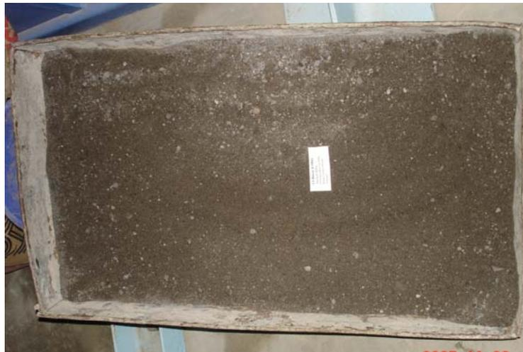
**Gambar 3.8.** Proses Pengeringan Pasir Kondisi SSD
