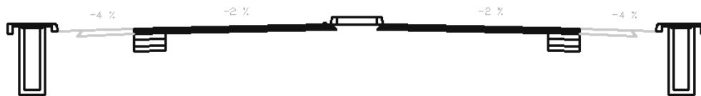
Gambar 6.9 Typical Design Saluran Drainase Dalam Kota Lasem
