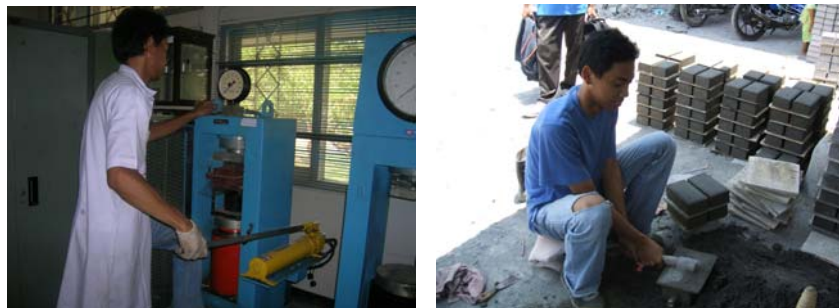
Gambar 3.1 Pembuatan Paving Block Metode Mekanis dan Konvensional
