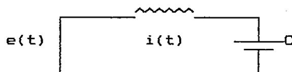
Jaringan RC sederhana yang diperlihatkan pada gambar diatas, mempunyai masukan arus  $i(t)$  dan keluaran tegangan  $e(t)$ . Apakah transformasi  $i(t)$  ke  $e(t)$  ini menyatakan sebuah sistem linier.
