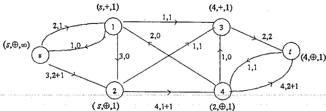
Gambar 2.15b. Titik-titik pada jaringan  $G(V, E, c, f)$  yang terkena labelling routine dan augmenting routine
