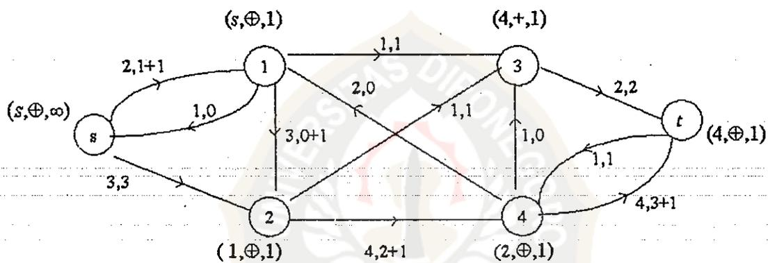
Gambar 2.16. Titik-titik pada jaringan  $G(V, E, c, f)$  yang terkena labelling routine dan augmentation routine
