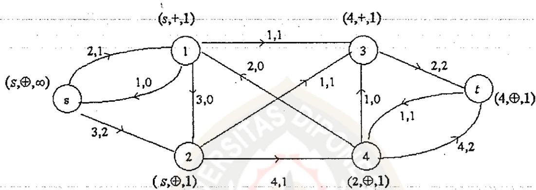
Gambar 2.15a. Titik-titik pada jaringan  $G(V, E, c, f)$  yang terkena labelling routine
