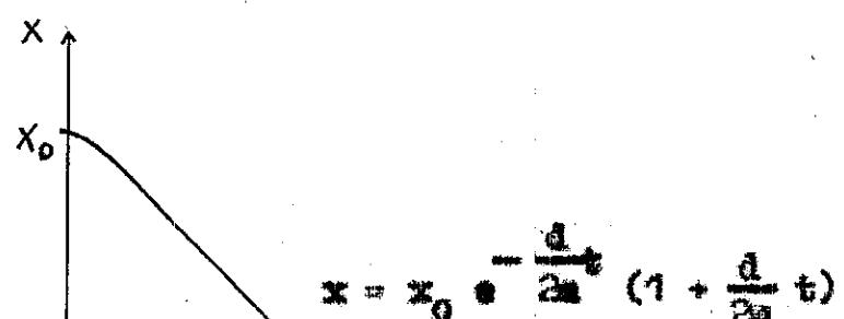
Gambar 5 memperlihatkan simpangan redaman kritis jika  $x = x_0$  dan  $v_0 = 0$  untuk  $t = 0$ .
