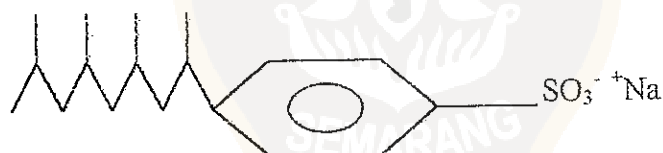
Gambar 1.5. Struktur Deterjen ABS (Perry, et.al, 1994)
