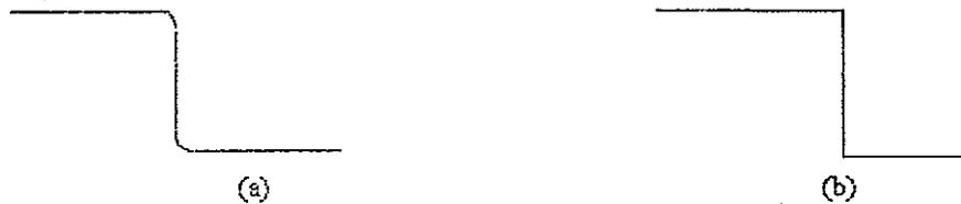
Gambar 2.9. Ilustrasi ketajaman pada suatu radiograf .(a) Gambar dengan batas kurang tajam (b) gambar dengan batas yang tajam (Meredith 1977).
