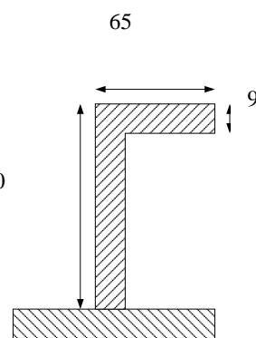
b) Modulus penampang deck beam pada midship kapal untuk jarak
