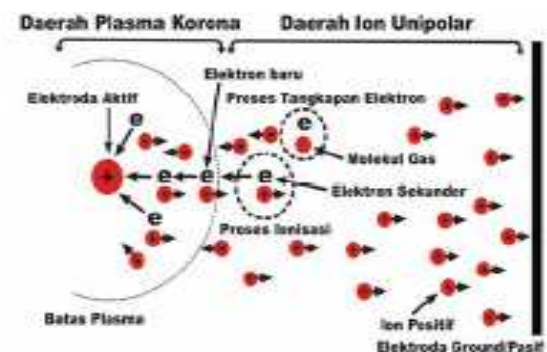
Gambar 1. Proses pembangkitan plasma lucutan pijar korona pada ruang antar elektroda [8].
