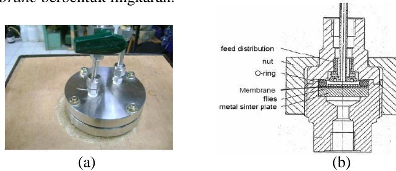
Gambar 5.2 Modul Untuk *Flat Sheet Membrane* Berbentuk Lingkaran
