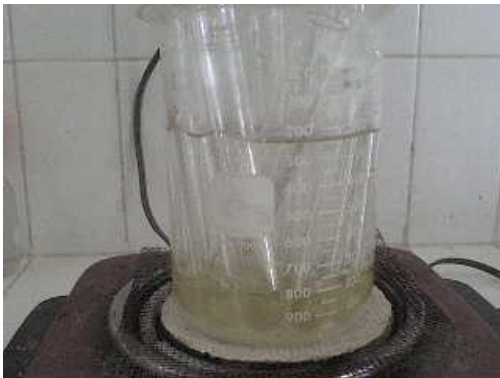
Gambar B.5. Analisa glukosa dengan metode DNS
